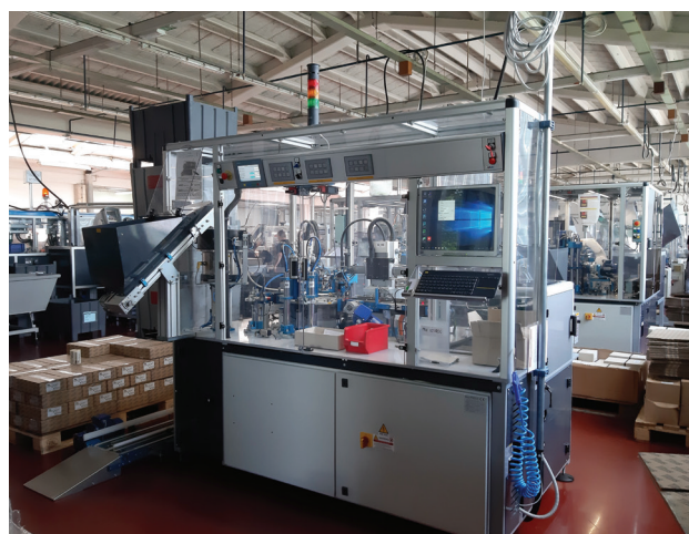
Transfer za sestavo steznika Quickfit
