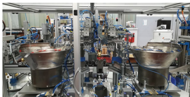
Sestava poteka na paletah transportnega sistema in na vrtljivih dozirnih mizah.
